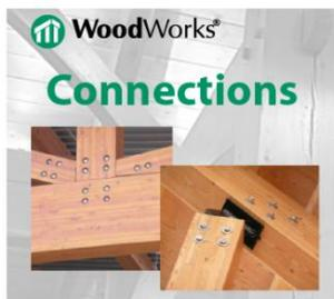
Con WoodWorks® Connections, puede diseñar conexiones formadas por pernos, tirafondos, tornillos para madera, clavos, placas de acero pesado y mucho más. Los resultados se muestran como dibujos de calidad CAD totalmente dimensionados.
