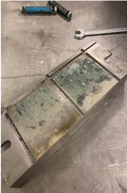
Figura 32: Foto de un moldeado de acero estándar, que muestra cómo la GPC se adhiere al acero.
