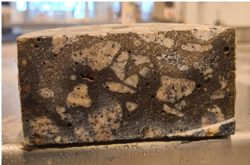
Figura 28: La profundidad de penetración del cloruro empieza a ser visible después de usar el AgNO_3
