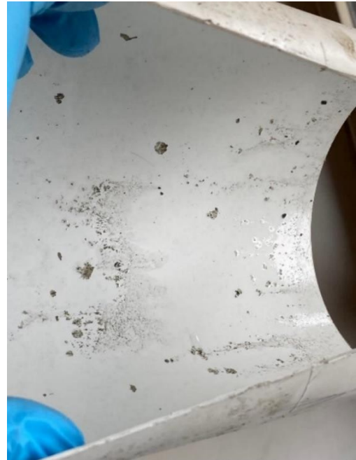
Figura 33: Fotografía del moldeado de plástico utilizado para los cilindros de ensayo de migración de cloruros.
