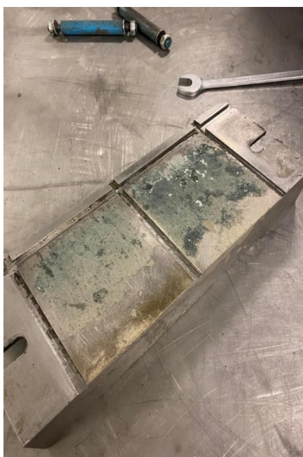
Figur 32: Foto av standard stålstøp, som viser hvordan GPC-en fester seg til stålet
