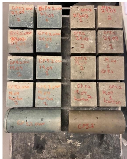
Figur 35: Foto etter avforming av GP5.2
