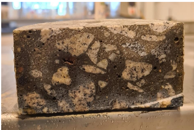
Figur 28: Kloridinntrengningsdybden begynner å bli synlig etter bruk av AgNO_3
