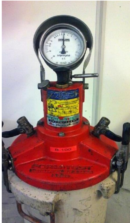
Figur 24: Verktøy for måling av luftinnhold, kontroll av luftinnhold i fersk betong (Vegdirektoratet, 2014)
