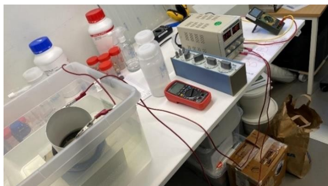
Figur 25: Oppsett av den faktiske testen, RCPT
