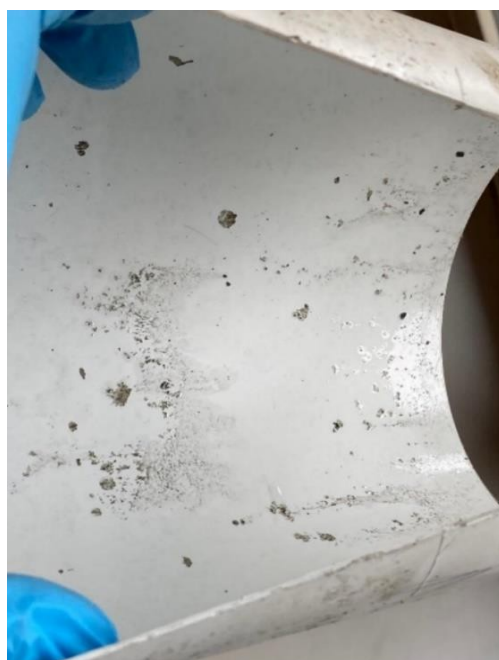
Figur 33: Foto av plaststøpingen som ble brukt til kloridmigrasjonstestsylindrene
