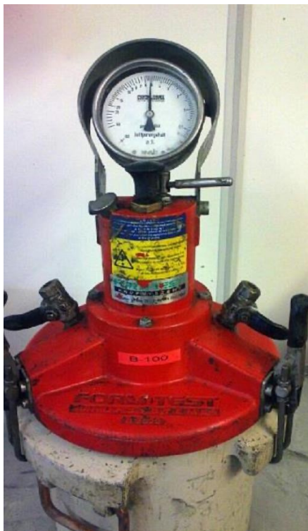
Figura 24: Instrument de măsurare a conținutului de aer, controlul conținutului de aer din betonul proaspăt (Vegdirektoratet, 2014)
