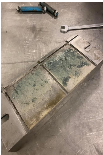
Figura 32: Fotografie a unei matrițe de oțel standard, care arată modul în care GPC aderă la oțel
