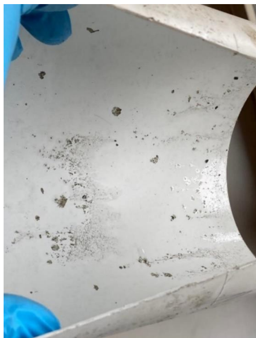
Figura 33: Fotografie a mulajului din plastic utilizat pentru cilindrii de testare a migrării clorurilor
