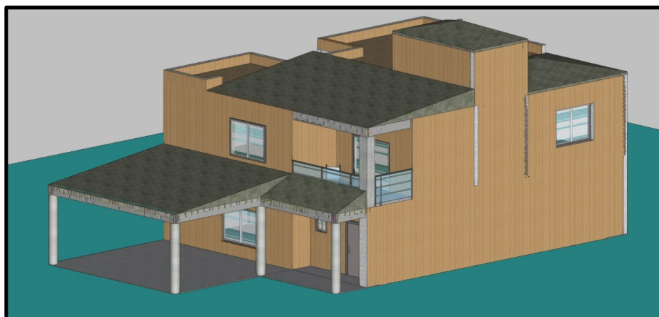
Figura 3. Casa con estructura y cerramiento de madera
