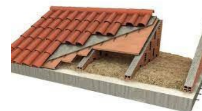
5.B - Acoperiș din țigle Tiled roof with brick walls
