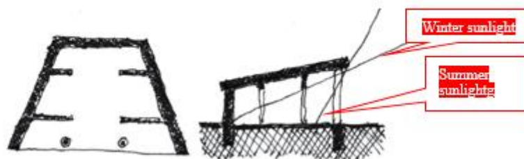
Figura 23 Schiță Ditoiu Nina-Cristina facsimil al potențialului solar al Megaronului Socratic, comentarii explicative-culoare Roșu / alb
