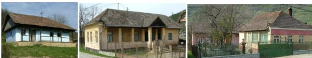
Figura 21 Prima imagine este o arhitectură tradițională din lemn. Terasa casei cu orientare sudică este un spațiu deschis. Acoperirea terasei protejează ușa de intrare și ferestrele de supraîncălzirea soarelui
