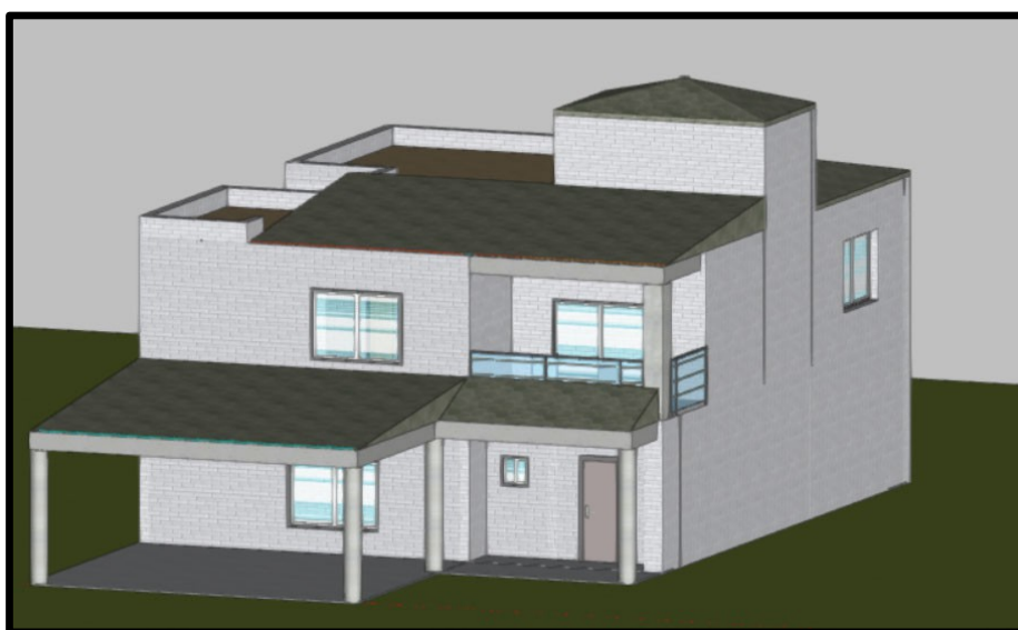
Studiu de caz: Casă unifamilială cu structură din beton și pereți din cărămidă
